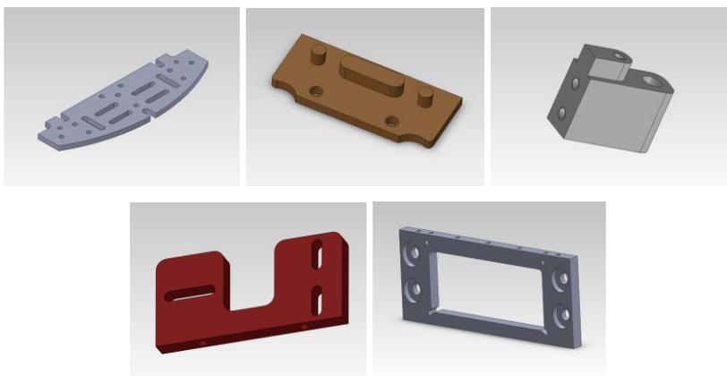
Базы, рамка и кронштейн двигателя изготавливаются на лазерно-гравировальном станке из оргстекла толщиной 3 мм. Соединительные элементы изготавливаются на 3D-принтере из ABS пластика, с последующим сверлением крепежных отверстий на торцевых поверхностях.
